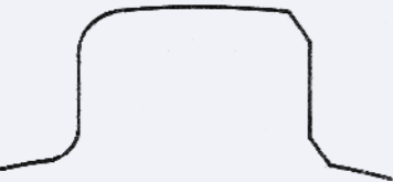
Radien und Fasen am Zahnfuß Radii and chamfers at minor and major diameter
