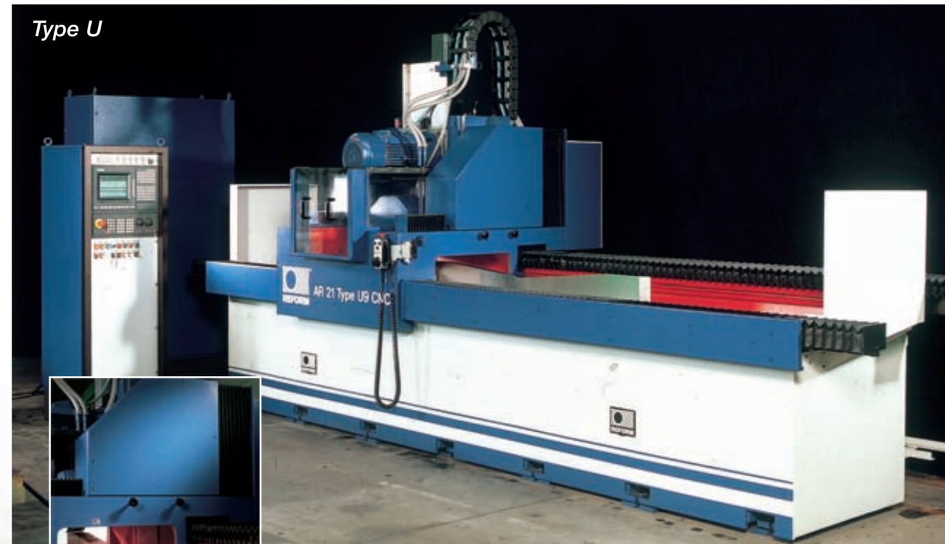
Schleifen mit Bogenmessern Grinding of curved knives
